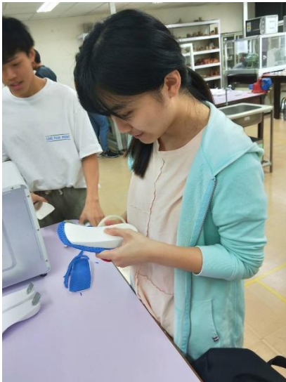
17. 用研磨機將鞋墊邊緣磨平
